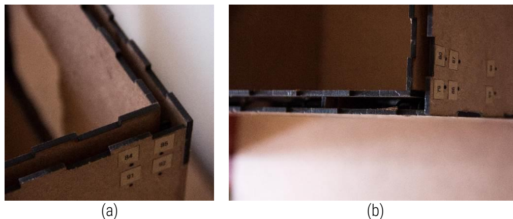
Figura 44: Detalhe da câmara de ar constituída entre as duas cascas do modelo para a passagem dos tubos plásticos conectados às tomadas de pressão e das guias para garantir o encaixe entre as peças.
