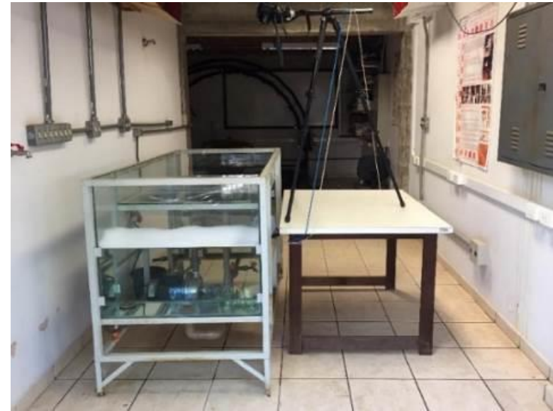
Figura 29: Mesa d'água do Laboratório de Conforto Ambiental (LCA) do IAU-USP. Figura 30: Sistema elaborado para a captura de imagens e vídeos dos ensaios em mesa d'água no LCA (IAU-USP).
