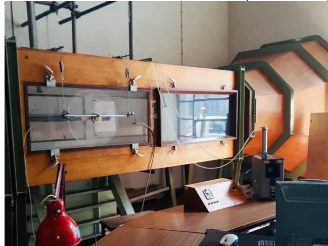
Figura 57: Túnel de vento do circuito fechado do LNEC utilizado para a calibração dos equipamentos.
