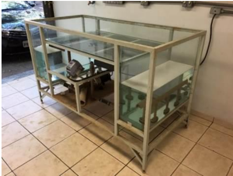
Figura 29: Mesa d'água do Laboratório de Conforto Ambiental (LCA) do IAU-USP. Figura 30: Sistema elaborado para a captura de imagens e vídeos dos ensaios em mesa d'água no LCA (IAU-USP).
