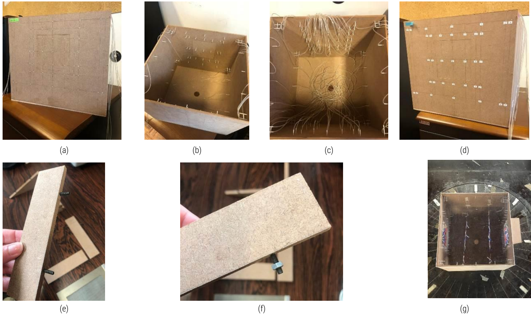
Figura 54: Processo de preparação do modelo físico reduzido.
