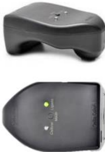
Figura 3.8 – Colorímetro de refletância Colorium 2
