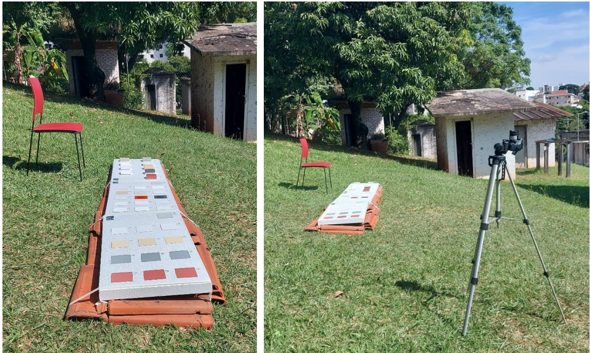
Figura 3.19 – Posição dos elementos no experimento com as amostras expostas ao Sol dispostas sobre as bancadas de isopor, a cadeira e o tripé com a máquina fotográfica
