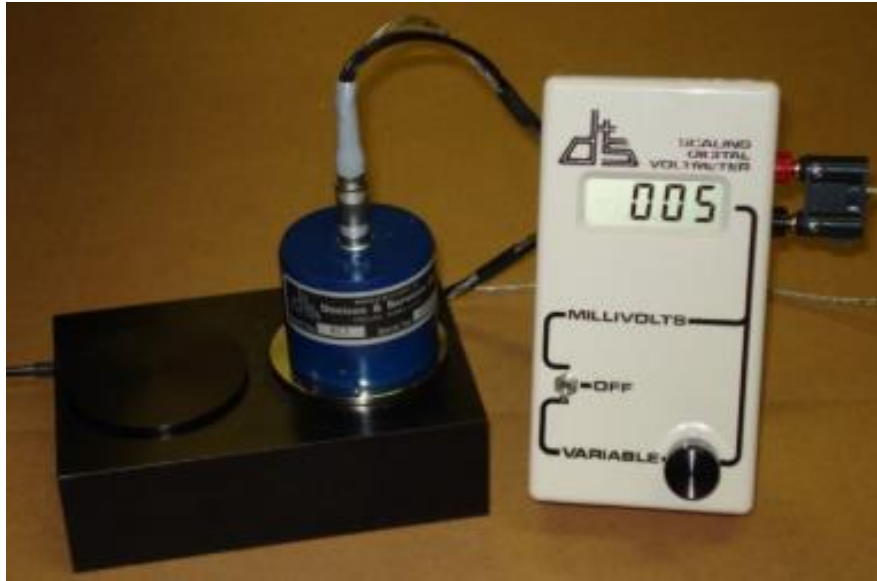
Figura 3.13 – Emissômetro portátil com voltímetro digital da Devices& Services
