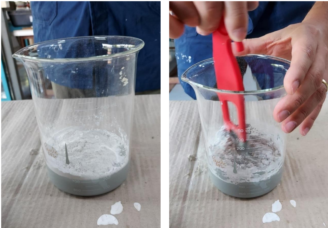
Figura 3.4 – Processo de incorporação e mistura da tinta acrílica ao pó aditivo refletivo
