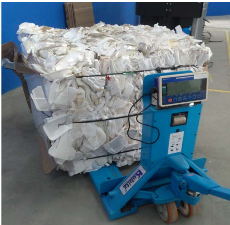
FOTO 7 - Balança com lançamento automático em sistema de controle
