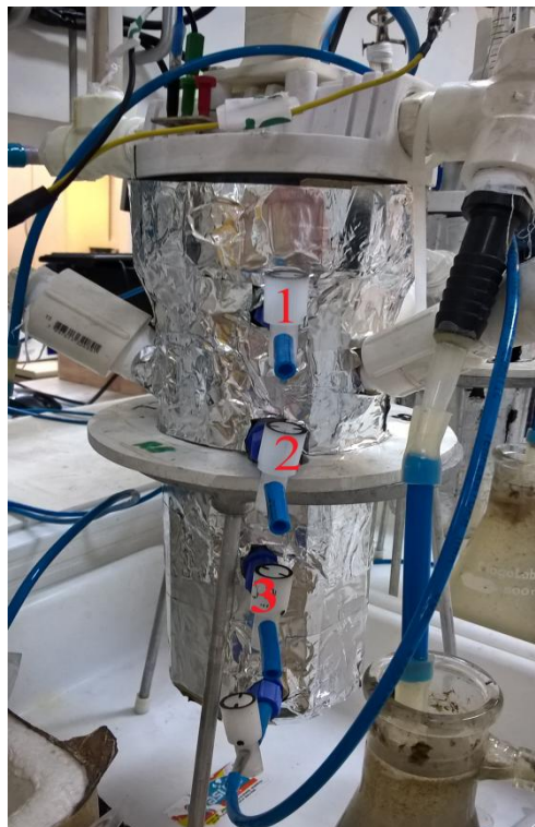
Figura 11 – Reator R3. Detalhe: as 3 saídas em diferentes alturas para coleta de amostras.
