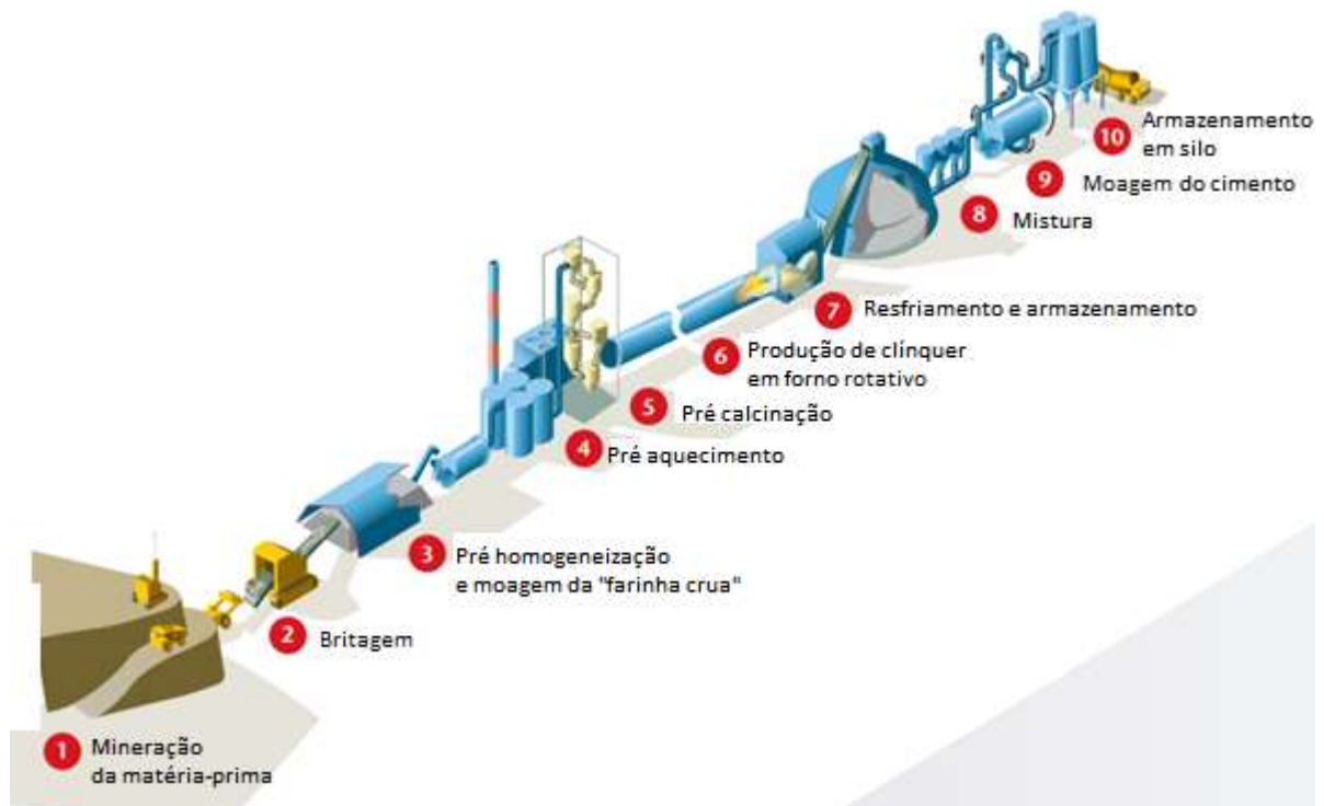
Figura 2- Etapas da produção de cimento (escopo cradle-to-gate )
