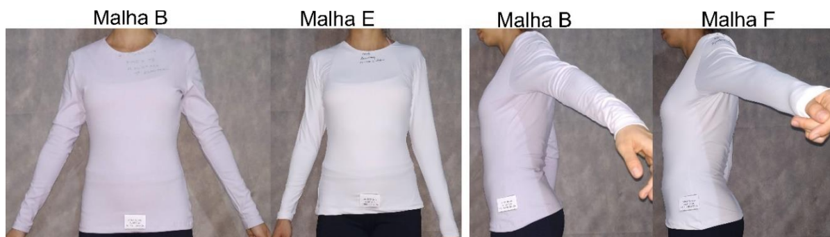
Figura 173 - Comparação entre as blusas ajustadas de Armstrong de 96% algodão e 4% elastano (malha B) e de 92% poliamida e 8% elastano (malha E).
