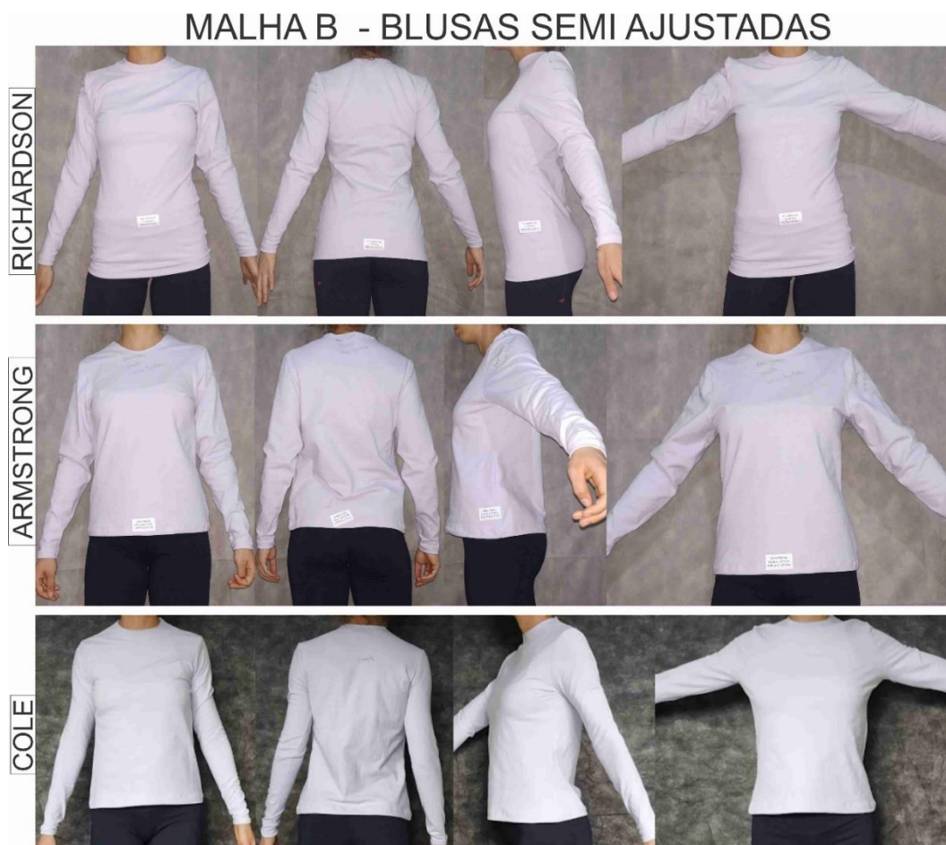
Figura 146 - Comparação entre blusas semi ajustadas de Richardson, de Armstrong e de Cole, confeccionadas na malha B (96% algodão e 4% elastano).
