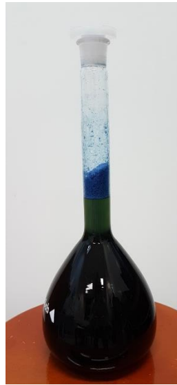
Figura 34 – Balão de 1000 mL com solução de banho contendo 2 \text{ g L}^{-1} de corante índigo
