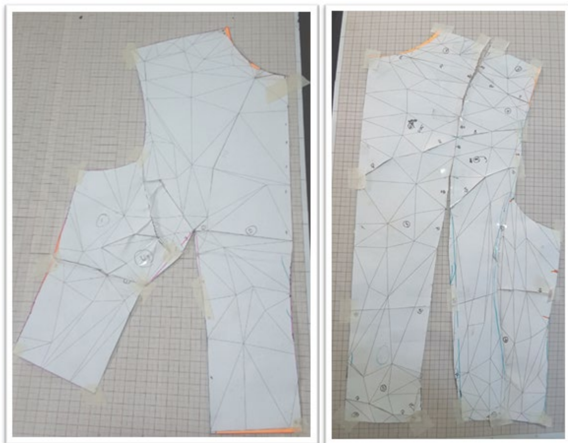
Figura 77 – Moldes frente e costas da base do corpo obtidos a partir do achatamento manual das malhas
