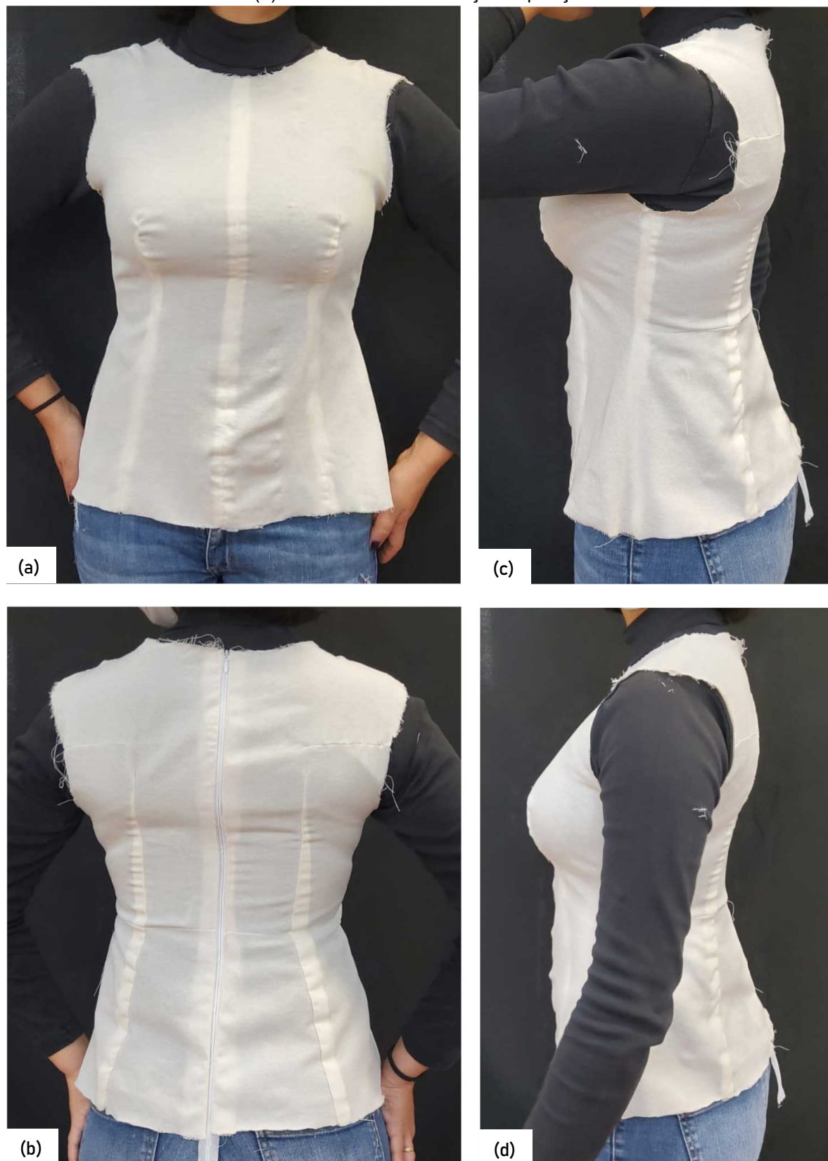
Figura 126 – Resultado base do corpo alongada com os moldes base gerados no software DazzticeCAD para a Pessoa 1. Em (a) visão dianteira (b) visão traseira (c) visão lateral com o braço levantado (d) visão lateral com o braço em posição relaxada.
