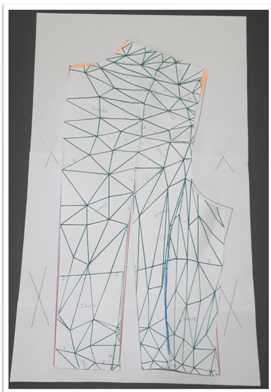
Figura 88 – Sobreposição do molde DazzticeDraft das costas e a malha 3D, das costas, reconstruída.
