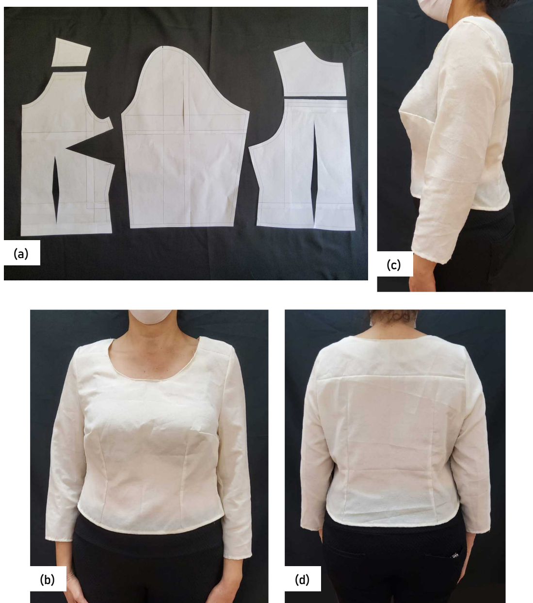
Figura 136 – Resultado do modelo da blusa 2 com os moldes adaptados gerados pelo software DazzticeCAD para a Pessoa 2. Em (a) os moldes adaptados, em papel (b) visão dianteira do modelo da blusa 2 (c) visão lateral do modelo da blusa 2 (d) visão traseira do modelo da blusa 2.
