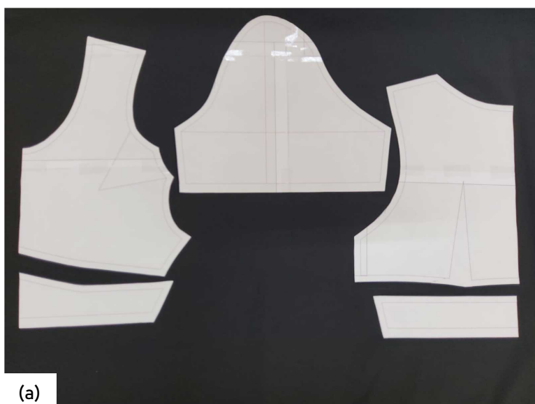
Figura 1 – Resultado da blusa com os moldes adaptados gerados pelo software DazzticeCAD para a Pessoa 2. Em (a) os moldes adaptados, em papel (b) visão dianteira do modelo da blusa 1 (c) visão lateral do modelo da blusa 1 (d) visão traseira do modelo da blusa 1.
