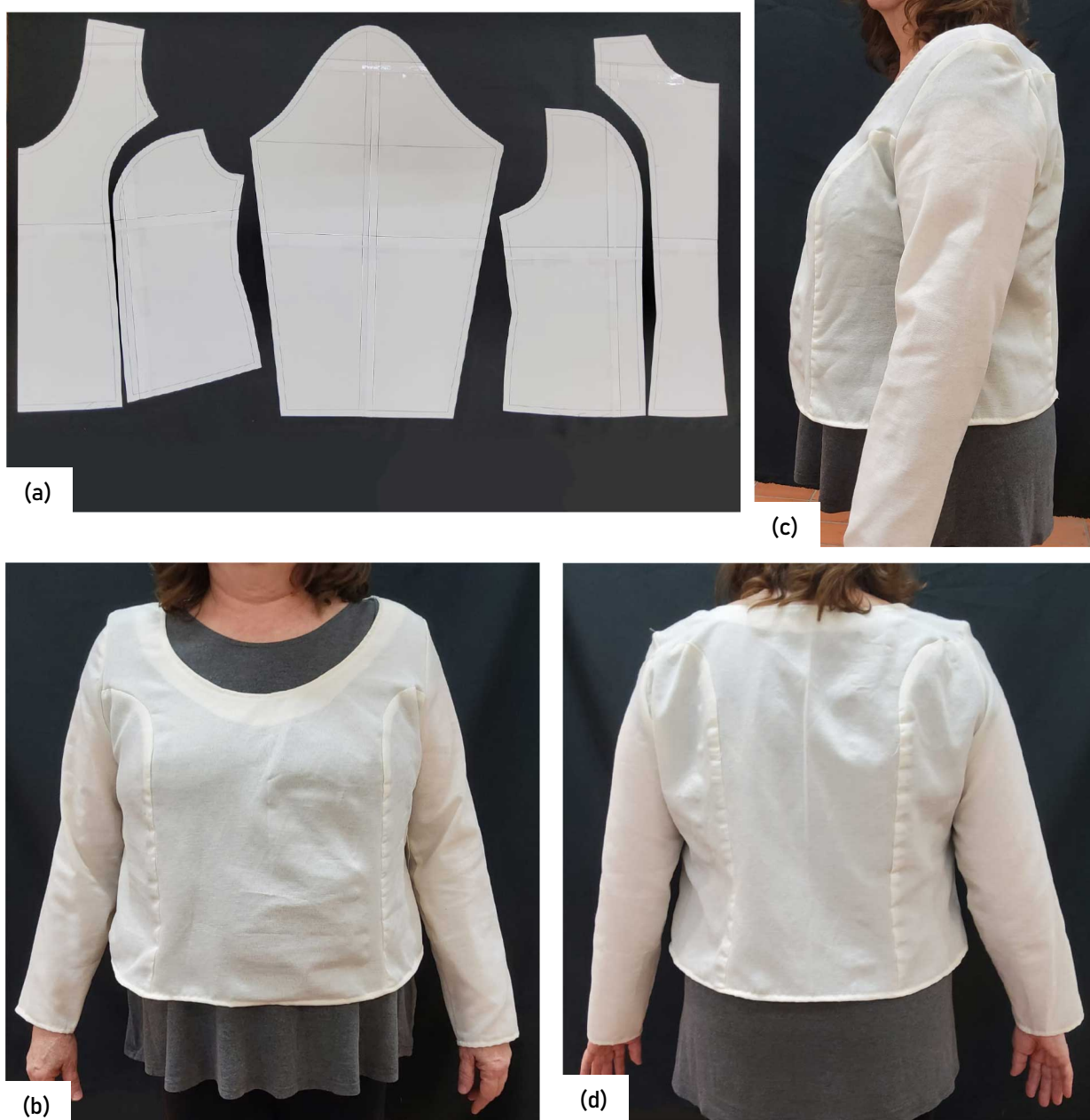
Figura 3 – Resultado da blusa com os moldes adaptados gerados pelo software DazzticeCAD para a Pessoa 5. Em (a) os moldes adaptados, em papel (c) visão dianteira do modelo da blusa 5 (d) visão lateral do modelo da blusa 5 (d) visão traseira do modelo da blusa 5.
