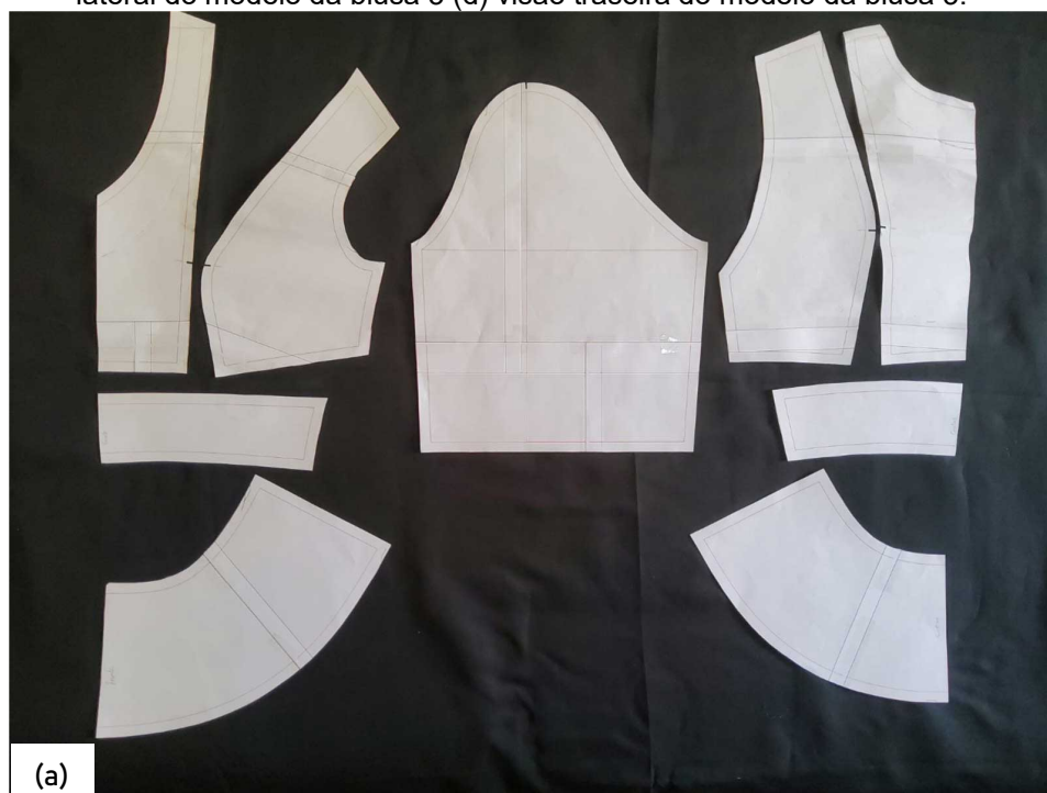
Figura 2 – Resultado da blusa com os moldes adaptados gerados pelo software DazzticeCAD para a Pessoa 3. Em (a) os moldes adaptados, em papel (b) visão dianteira do modelo da blusa 3 (c) visão lateral do modelo da blusa 3 (d) visão traseira do modelo da blusa 3.
