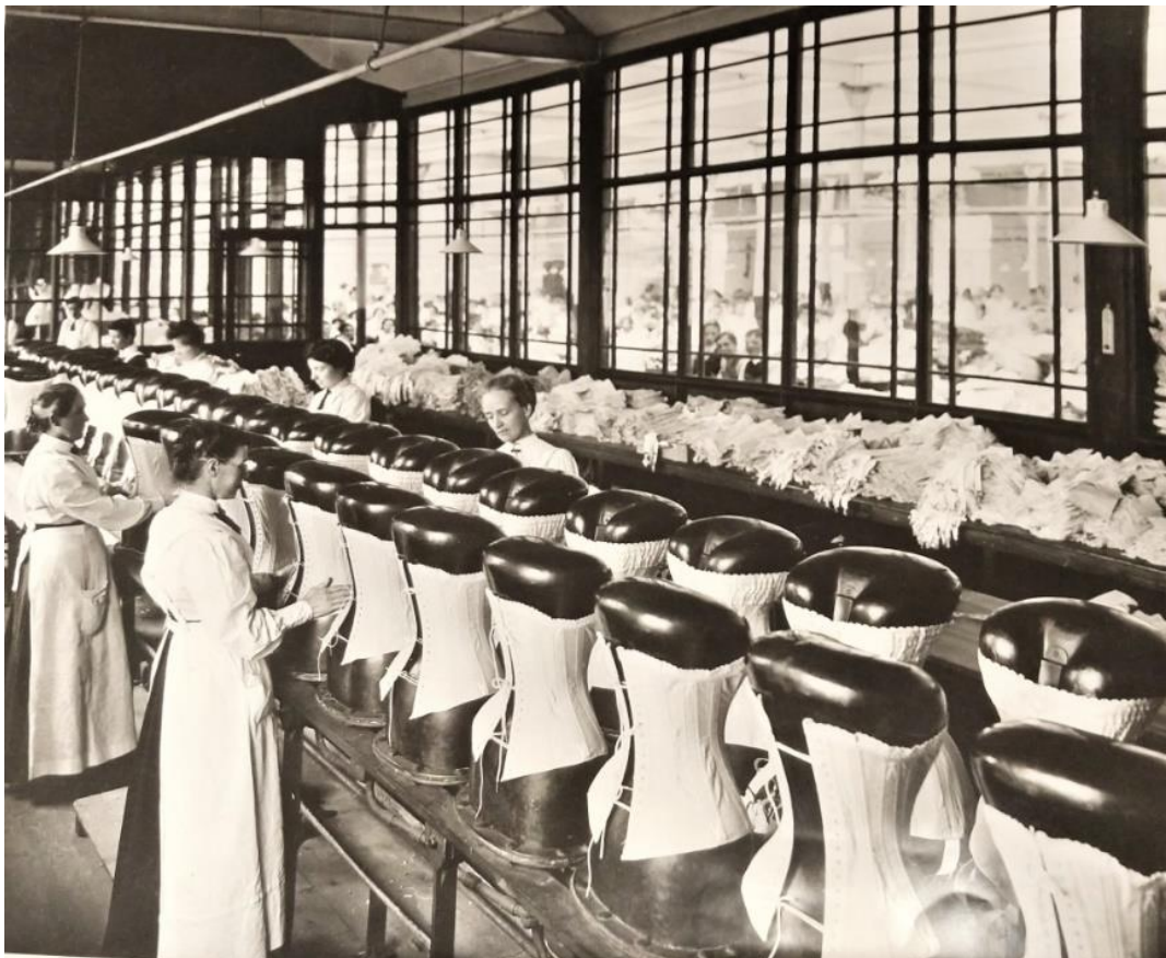
Figura 41 - Procedimento de Moldagem a Vapor da R. & W.H. Symington & Co (1900)
