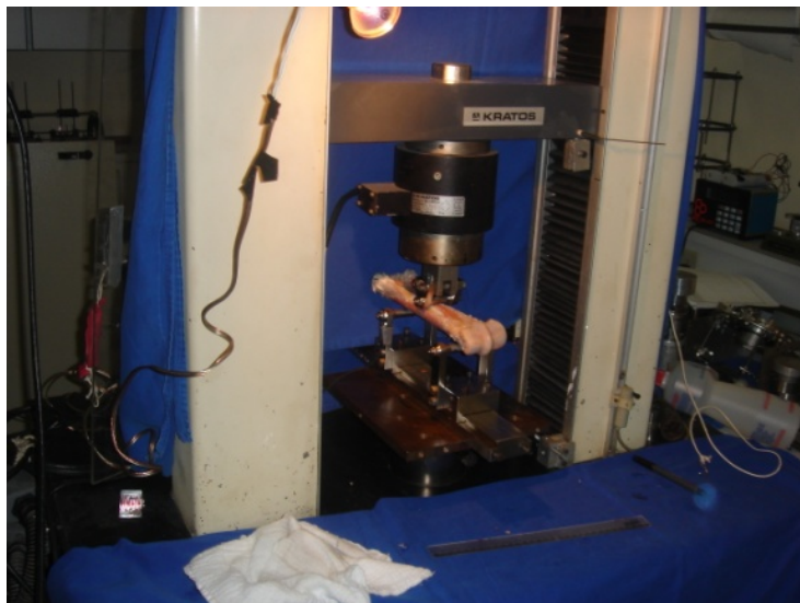
Figura 7 - Osso terceiro metacarpiano posicionado para o ensaio de flexão
