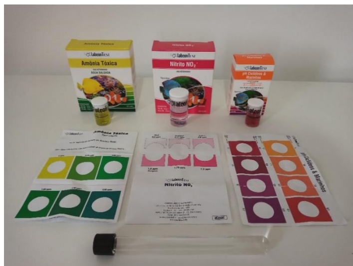
Figura 5 - Análise da qualidade da água fornecida às tartarugas-verdes ( Chelonia mydas ) incluídas neste estudo por meio de kits colorimétricos comerciais.
