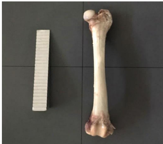
Figura 1 – Fêmur e escala de alumínio (penetrômetro) posicionados diretamente sobre o cassete para realização das radiografias
