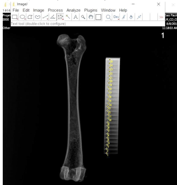
Figura 2 – Ferramenta “ponto” para seleção de cada degrau da escala de alumínio
