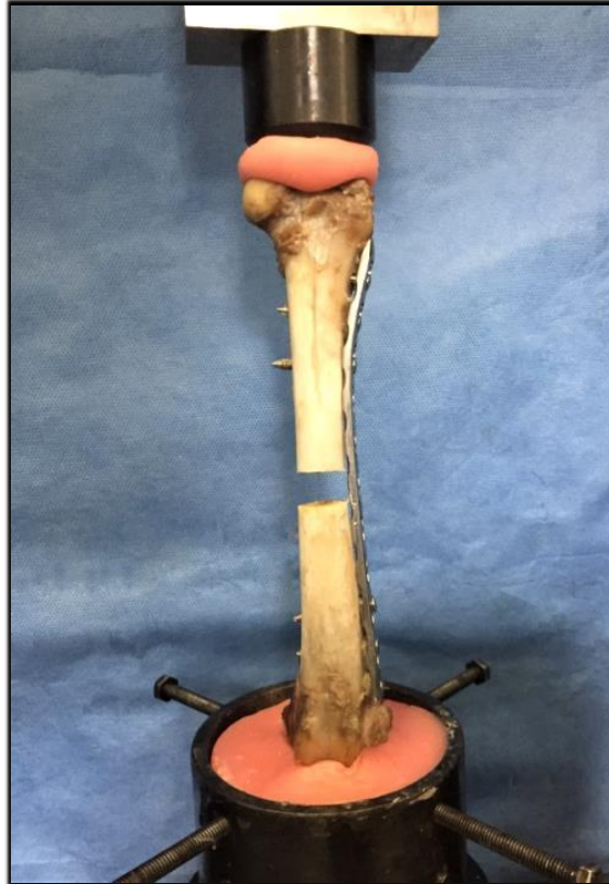
Figura 8 – Posicionamento do fêmur do grupo ponte no dispositivo para realização do ensaio biomecânico
