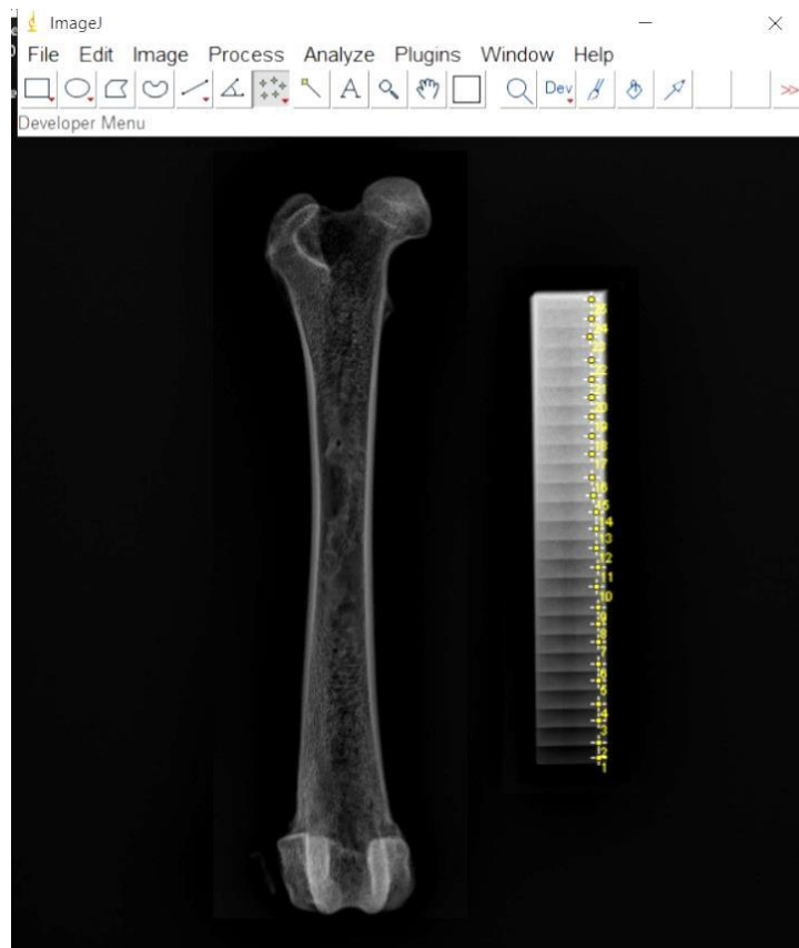
Figura 2 – Ferramenta de seleção “ponto” utilizada para aferir a tonalidade de cinza de cada degrau de alumínio do penetrômetro, utilizando o programa ImageJ 1,46r® padronizada individualmente para cada fêmur.
