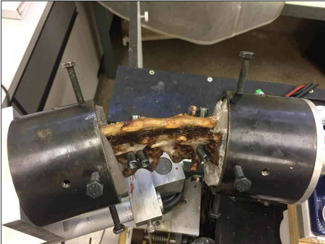
Figura 17 - Segmento durante teste biomecânico de inclinação lateral.
