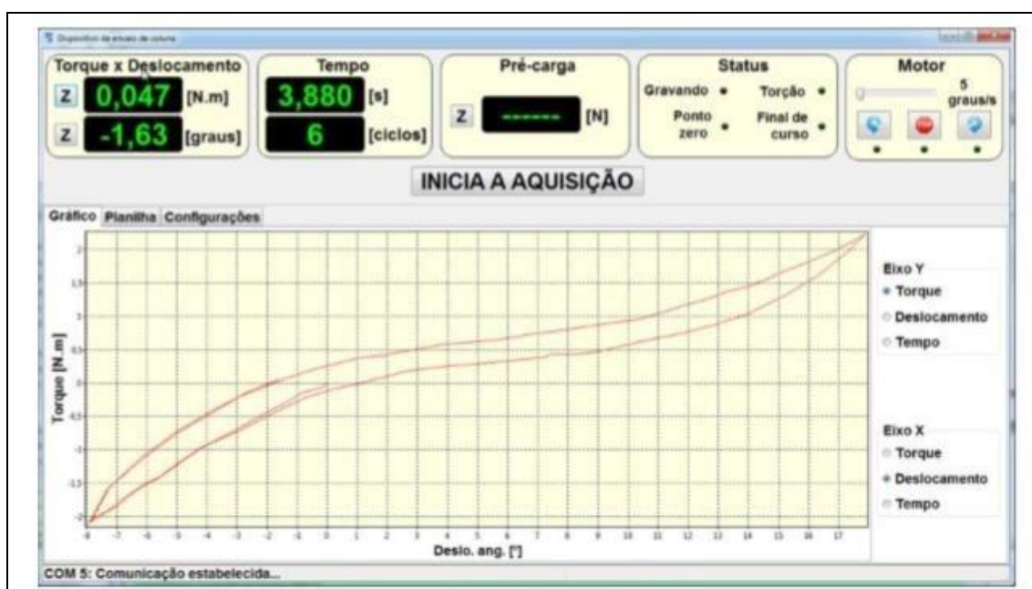
Figura 21 - Programa de aquisição do dispositivo de ensaio de coluna.
