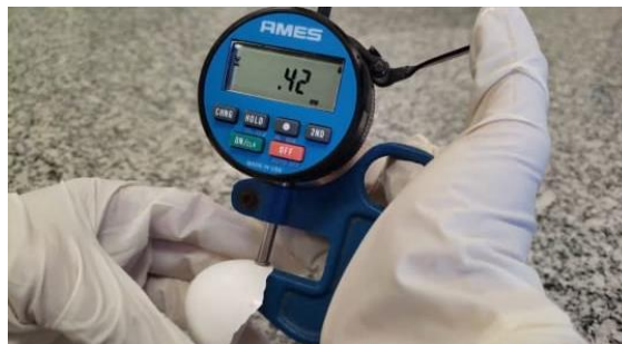
Figura 10 – Espessura de casca com micrômetro digital Ames® 25M-5. São Paulo – 2020.
