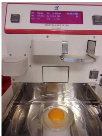
Figura 8 – Determinação eletrônica da unidade Haugh por meio do aparelho EggTester® DET6000. São Paulo – 2020.
