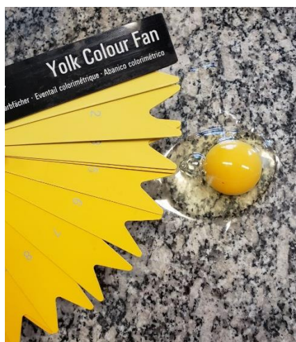
Figura 9 – Determinação da cor da gema com Yolk Colour Fan. São Paulo – 2020.
