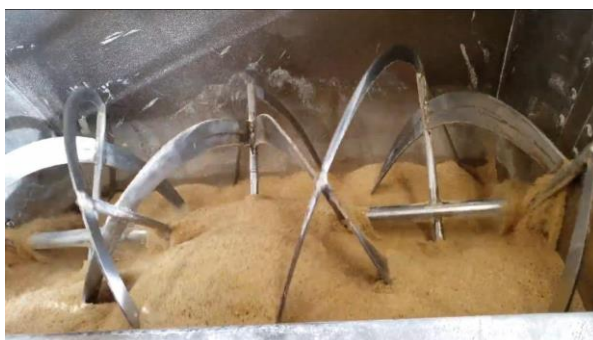
Figura 3 – Misturador tipo horizontal helicoidal utilizado para ingredientes de maior escala. São Paulo – 2020.
