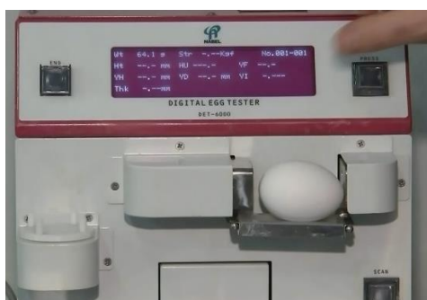
Figura 11 – Determinação eletrônica da resistência da casca com o aparelho EggTester® DET6000. São Paulo – 2020.
