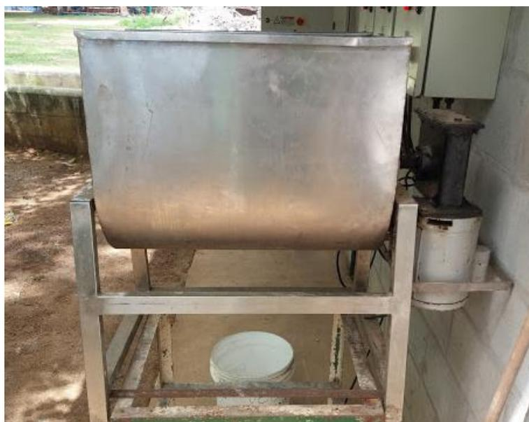
Figura 3 - Misturador utilizado na pré-mistura.
