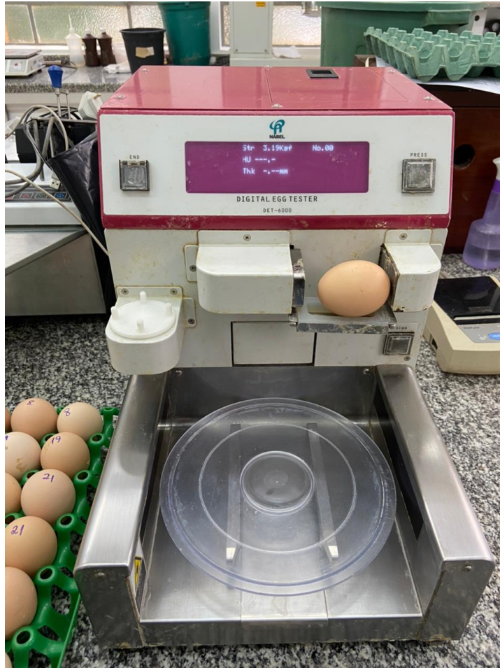
Figura 5. Máquina Digital Egg Tester para avaliação da qualidade do ovo
