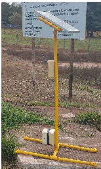
Figura 17 - Estrutura experimental em PVC para acomodação do hardware.
