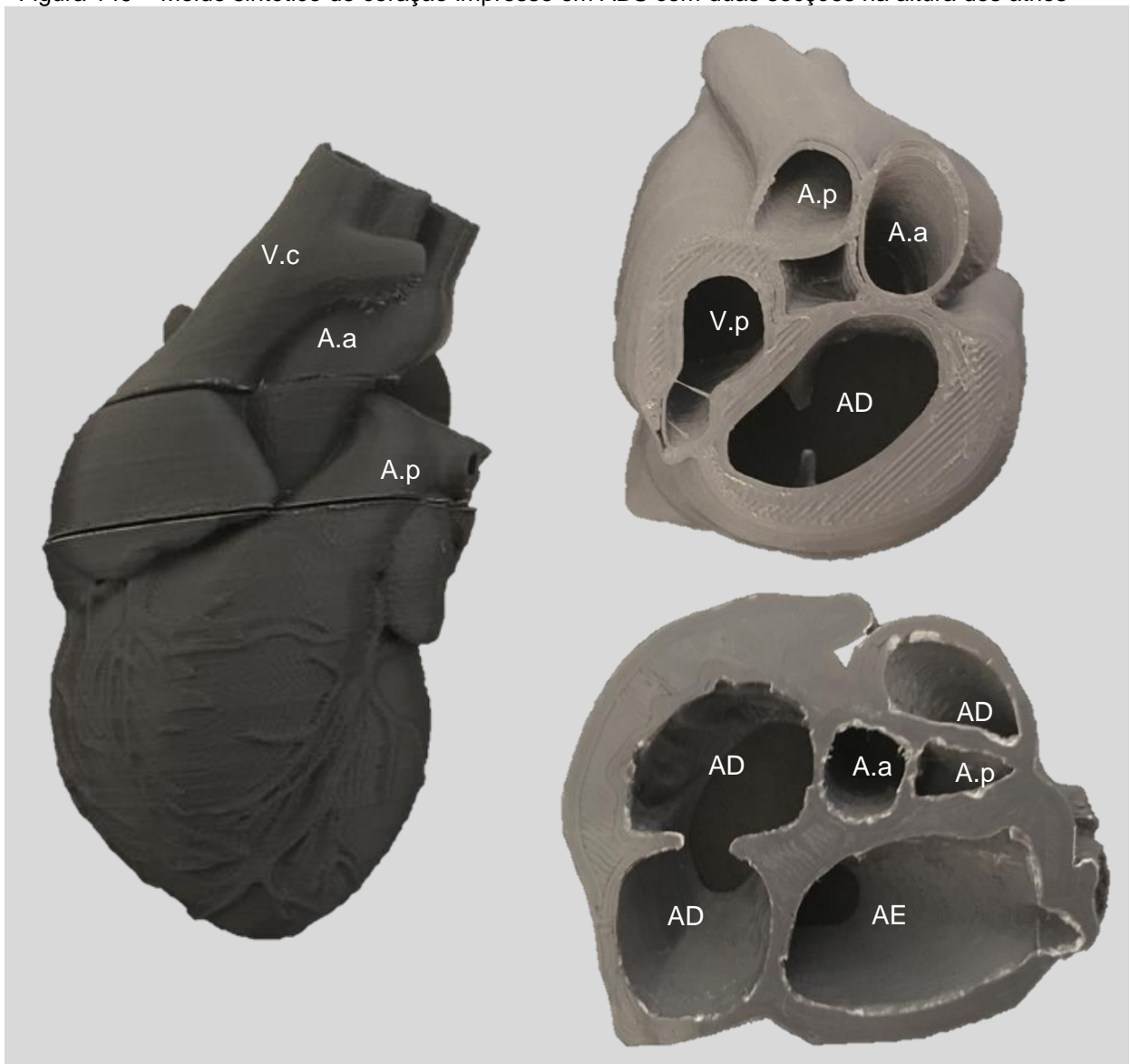
Figura 149 – Molde sintético de coração impresso em ABS com duas secções na altura dos átrios
