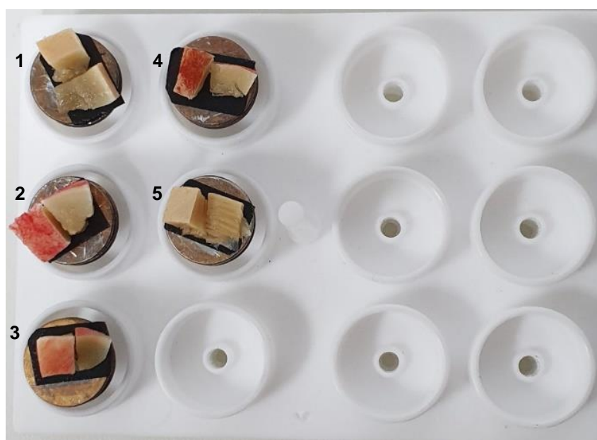
Figura 36 – Suporte com as amostras em duplicatas processadas extraídas dos respectivos espécimes de ratos Wistar e destinadas ao processamento para microscopia eletrônica de varredura
