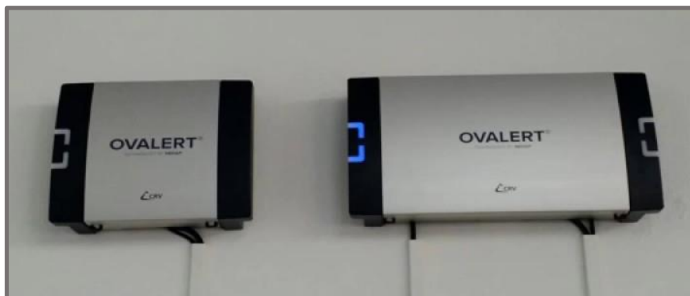
Figura 32 - Controlador e processador do dispositivo de monitoramento de atividade (DMA).
