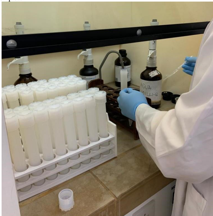
Figura 3 - Após o resfriamento dos tubos de politetrafluoretileno (Teflon®), foram abertos na capela de exaustão e seus conteúdos transferidos para tubos de centrifuga, onde água deionizada foi adicionada ultrapura até completar 14 ml.
