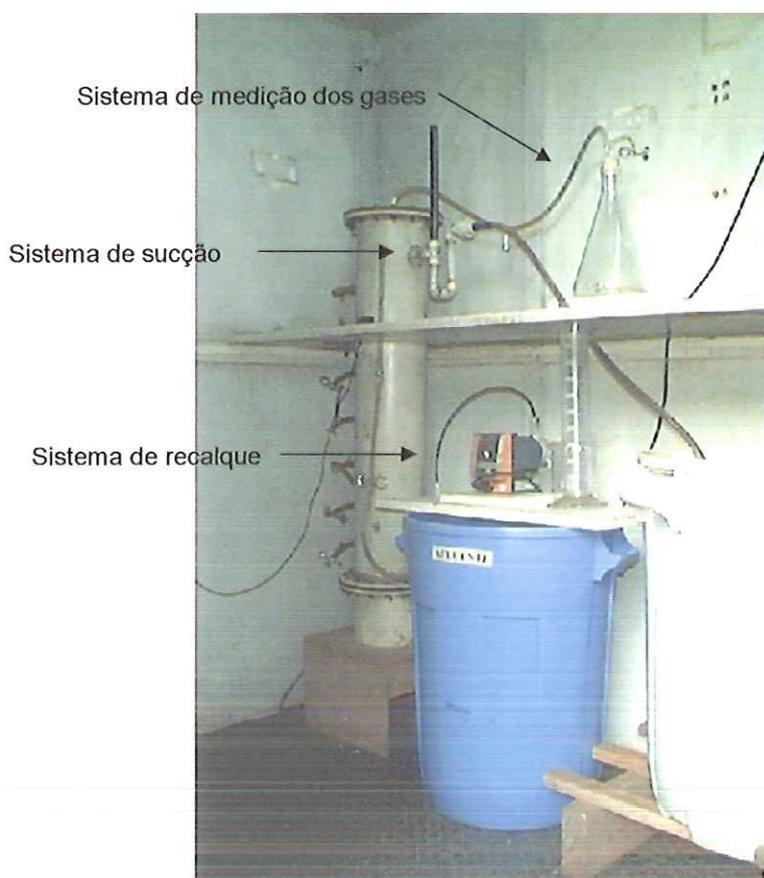
Figura 4.3 – Reator anaeróbico e seus sistemas de recalque e sucção
