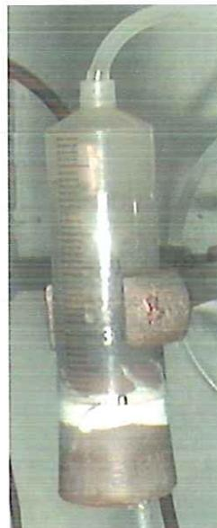
**Figura 4.11 – Reator diferencial com suporte**
