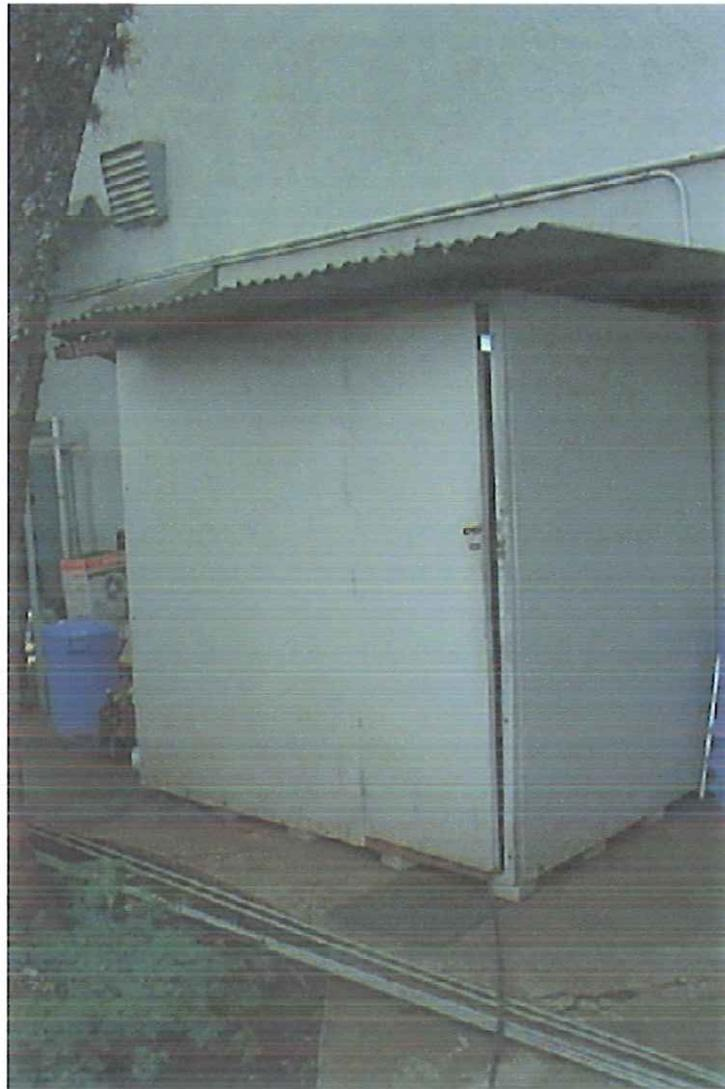
**Figura 4.4 – Câmara climatizada de madeira**
