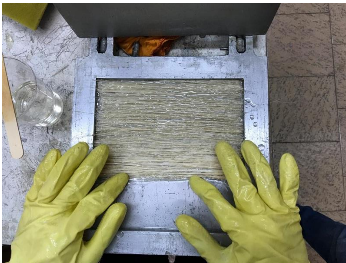
Figura 19 - Preparação do compósito de fibra natural contínua
