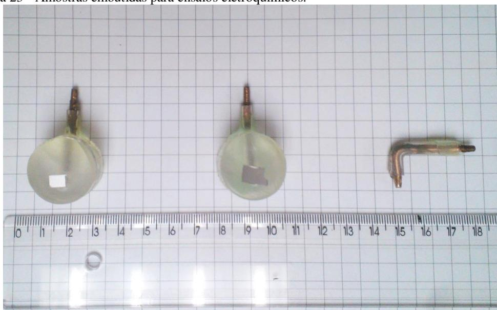
Fonte: Arquivo pessoal. Da esquerda para direita: amostra solidificada unidirecionalmente e reduzida 91 % em área a frio por forjamento rotativo swage; amostra solidificada unidirecionalmente e reduzida 91 % em área a frio por forjamento rotativo swage e recristalizada; suporte de cobre utilizado como contato elétrico.
