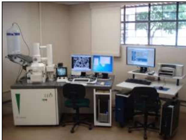
Figura 15 – Imagem ilustrativa do microscópio eletrônico de varredura da marca LEO modelo LEO 1450 VP, do DEMAR-EEL-USP.
