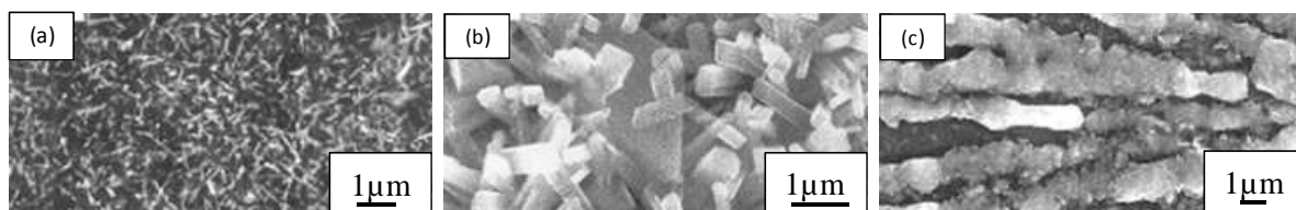
Figura 20 – (a) Oxidação da matriz rica em ferro, wiskers , (b) oxidação do MC e (c) oxidação do M_2C
