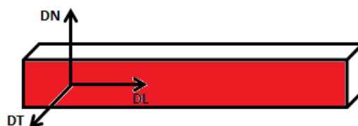
Figura 16 – Representação da superfície preparada para inspeção metalográfica (face DL x DN).
