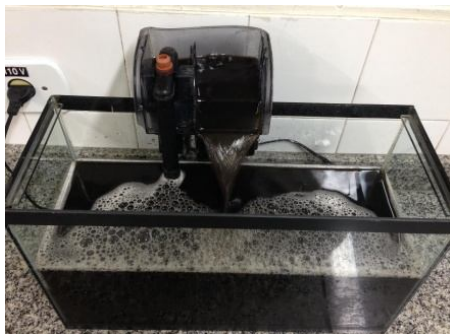
Figura 10 – Tratamento biológico em escala laboratorial para avaliação da degradação de cianeto
