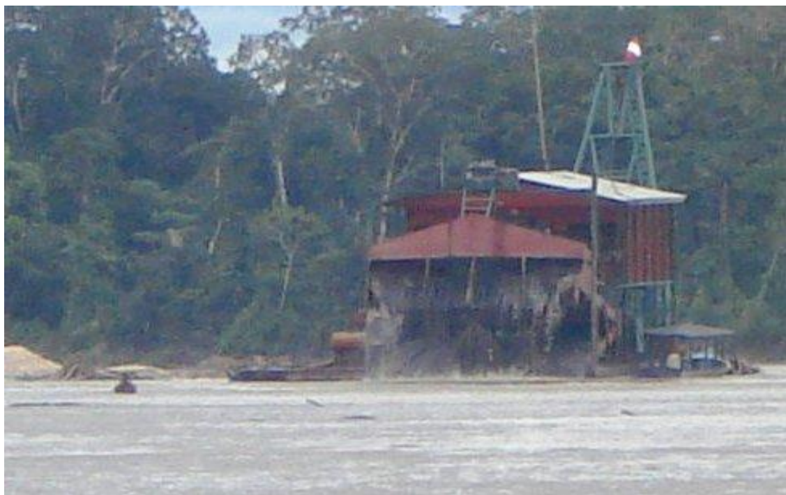
Figura 13 - Dragagem de sucção na exploração aurífera no Rio Madre de Dios (foto: Jorge Luis Ferrer Uribe, 2009)
