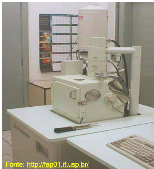
Figura 38 – Microscópio Eletrônico de Varredura (MEV) JEOL 6460LV.
