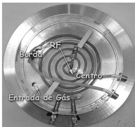
Figura 36 – Vista interna do dispositivo de acoplamento indutivo (posição da bobina).
