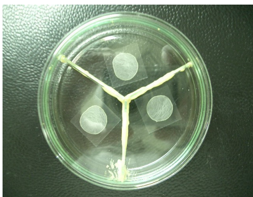
Figura 28 – Suportes vítreos contendo esporos de B. atrophaeus , em placa de Petri, destinados às validações dos sistemas de plasma.
