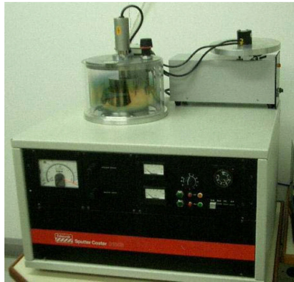
Figura 40 – Equipamento de deposição de ouro marca Edwards, modelo “ sputter coater 5150B ”.
