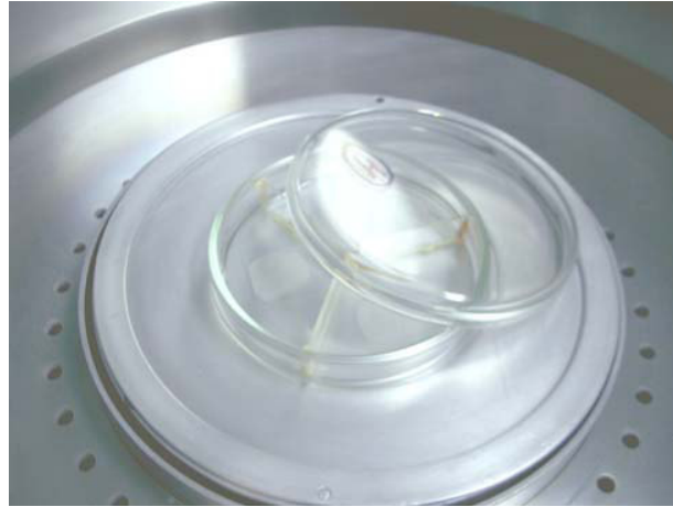
Figura 32 – Placa de Petri sobre o eletrodo (cátodo) no interior da câmara do sistema de plasma com acoplamento capacitivo modo Reactive Ion Etching (RIE).
