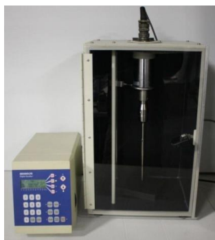
Figura 29 Sonicador Branson Digital Sonifier 450:400 W, 20 KHz.
