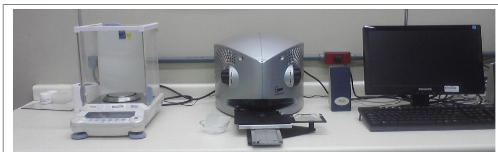
Figura 7 – Espectrofotômetro equipado com detector tipo esfera de integração (Ultraviolet Transmittance Analyzer, UV2000S, Labsphere, US) usado para avaliação in vitro da proteção solar da nanoemulsão. Foto: Laboratório de Cosmetologia, Universidade de São Paulo
