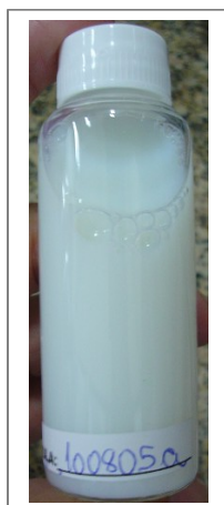
Figura 4 – Emulsão com aspecto translúcido e brilho azulado, obtida através do método da PIT . Foto: Laboratório de Cosmetologia, Universidade de São Paulo
