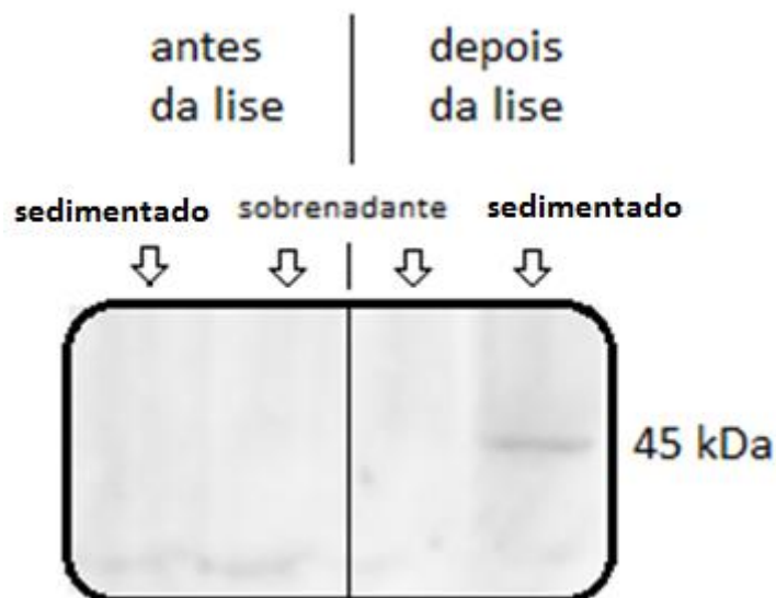
Figura 13: Fotografia da membrana do Western blotting das amostras antes e depois da lise por ultrassom, respectivamente, em destaque a banda com tamanho de 45 kDa presente apenas na amostra do sedimentado após a lise, que contém a fração insolúvel, com os corpos de inclusão.
