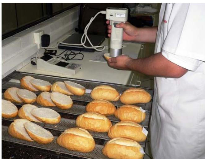
Figura 31. Determinação de cor em pães usando um colorímetro tipo Minolta.
