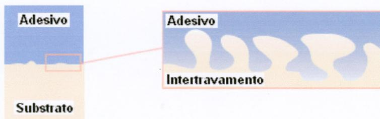
**Figura 02** – Ilustração do mecanismo de intertravamento mecânico
