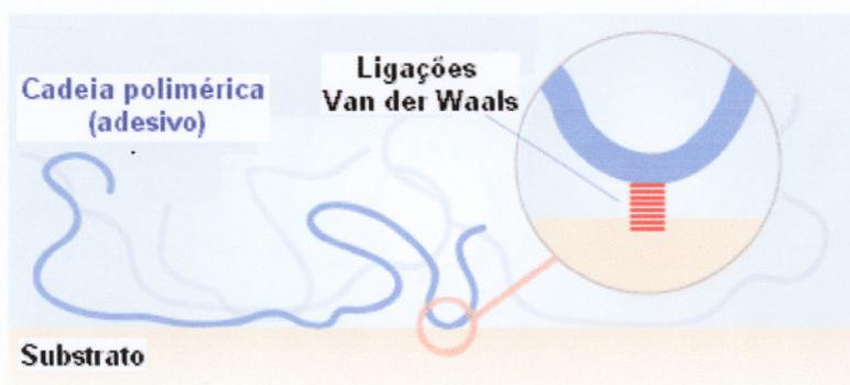
**Figura 04** – Ilustração do mecanismo de adsorção
