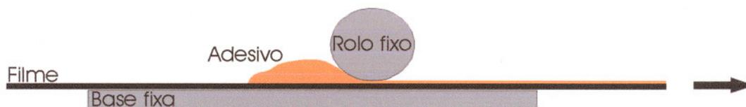
**Figura 38** - Montagem para revestimento de substrato com adesivo
