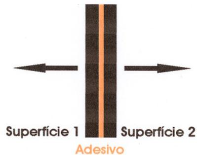
*Figura 12 - Ilustração de um esforço sob tensão*
