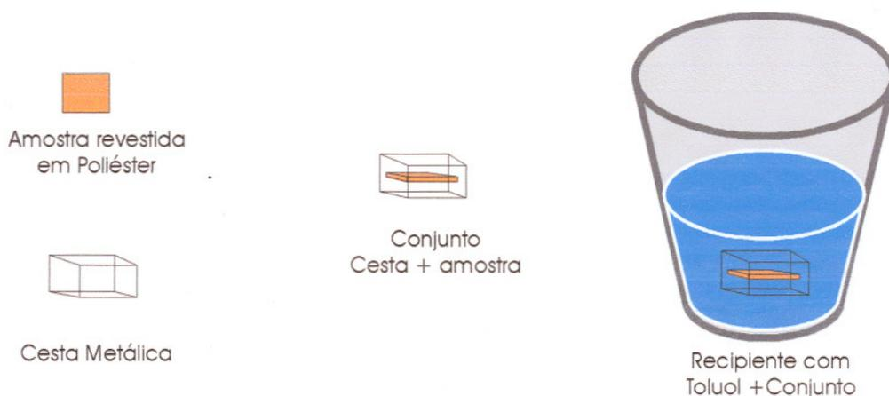
**Figura 49** - Ilustração da montagem para determinação do grau de ligações cruzadas
