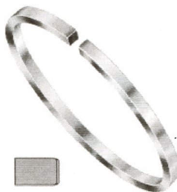
Figura 2: Representação de um anel de compressão revestido com cromo.
