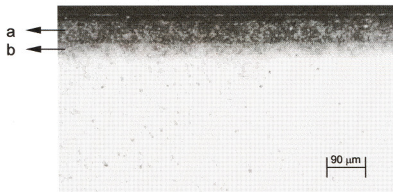
Figura 46: Vista da camada nitretada por plasma, onde a) é a zona de difusão e b) é a zona de transição.
