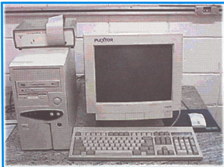
FIGURA 19 - Sistema de aquisição de dados utilizado no levantamento das curvas e taxas de resfriamento
