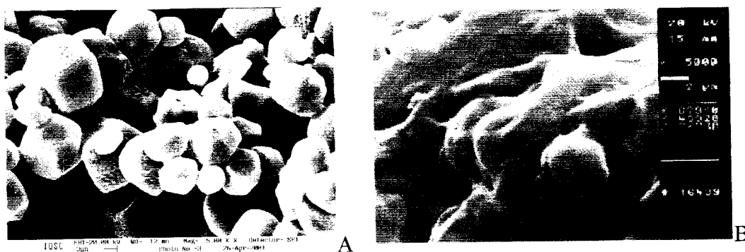
Figura 62. Micrografias obtidas por SEM dos grânulos de amido (A) e do derivado entrecruzado com 99% de OPOPTD (B), ambas com 5000 vezes de aumento.
