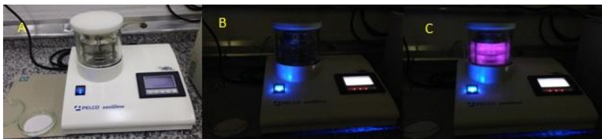
Figura 15 – Equipamento utilizado para preparo de grades de microscopia eletrônica de transmissão - Easy Glow. A – Equipamento usado para preparar as grades carregadas negativamente; B – Ausência de corrente nas grades; C – Presença de corrente negativa nas grades.
