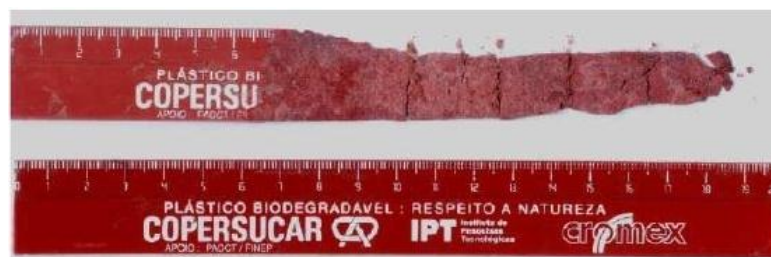
Figura 10 - Duas régua utilizadas em um teste caseiro de biodegradabilidade durante 6 meses. (FONTE: PICCOLI, 1991)
