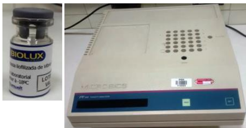
Figura 21 – Frasco de bactéria ( Vibrio fischeri ) liofilizada e aparelho Microbics M500 Toxicity Analyzer para realização das análises de toxicidade (Foto tirada pelo autor, 2014).
