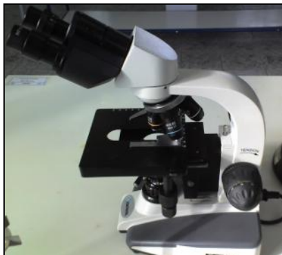
Figura 18 – Microscópio ótico Bioval usado nas análises microscópicas do lodo.
