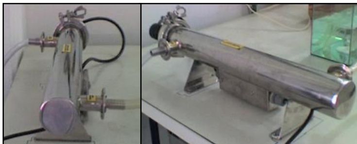
Figura 11 – Reator de desinfecção tubular.
