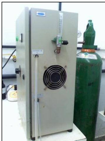
Figura 12 – Gerador de O_3 , vazão medida por rotômetro, cilindro de oxigênio introduzindo o gás pela mangueira superior, saída da mistura gasosa O_2 - O_3 pela mangueira na parte inferior.
