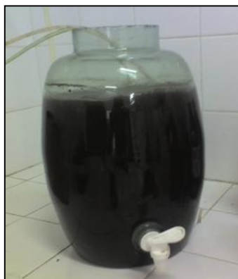
Figura 15 – Reator biológico para aclimação do lodo ativado .
