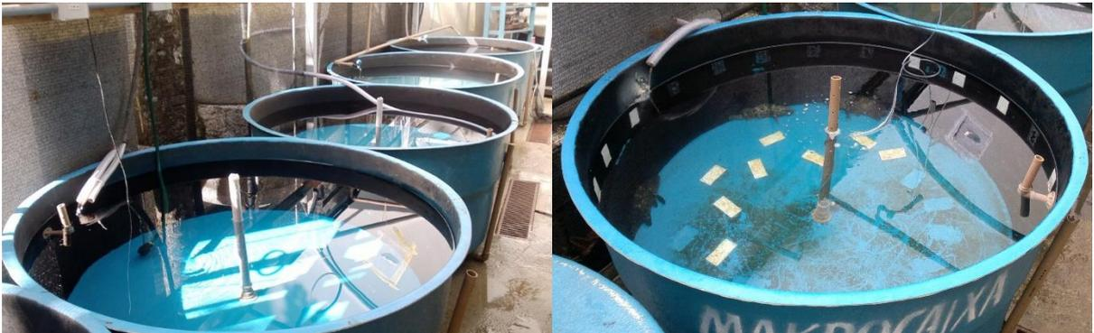
**Figura 29.** A imagem à esquerda apresenta a posição de cada tanque na estufa de trabalho (O tanque 1 está em primeiro plano e o tanque 4 está posicionado ao fundo). À direita é apresentado um dos tanques utilizados no experimento ainda com alguns corpos de provas fixados no fundo e nas paredes do tanque.
