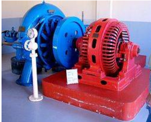
Figura 10 – Gerador Síncrono com Excitatriz Fonte: http://www.rmsenergia.com.pt
