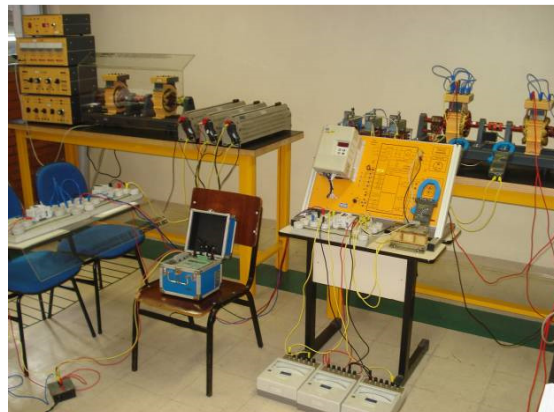
Figura 81 – Detalhe do inversor de frequência utilizado para regulação da frequência dos modelos
