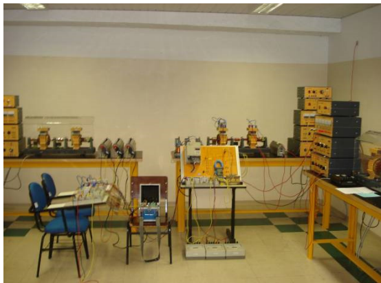
Figura 80 – Montagem do modelo para simulação dos aerogeradores com analisador de energia acoplado
