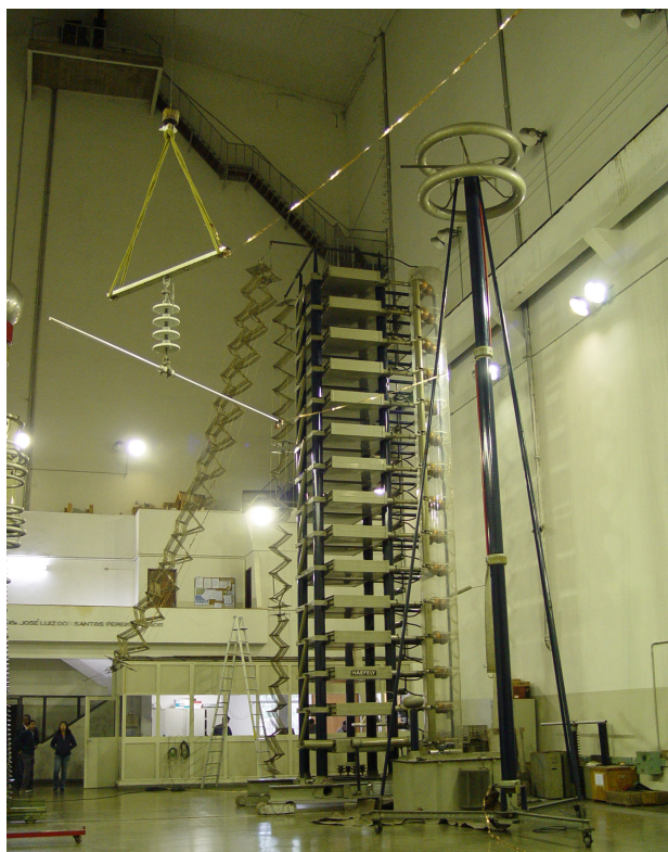
Figura 5.15 Montagem da cadeia de isoladores para ensaio
