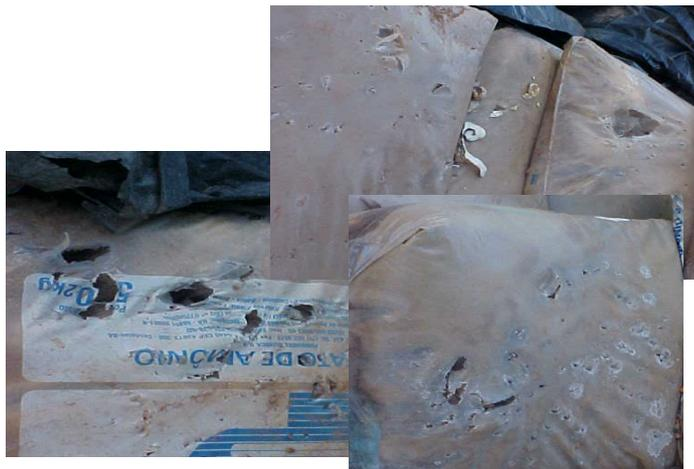
**Figura 4.15** Vista em detalhe da sacaria rasgada, comprometendo a qualidade do adubo.
