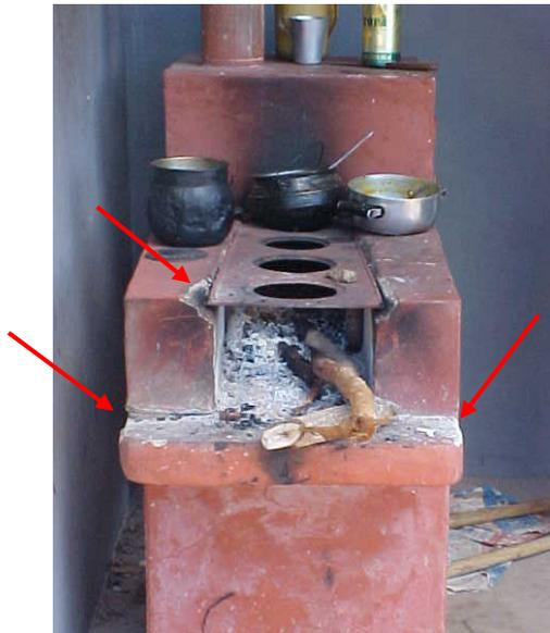
**Figura 4.4** Fogão a lenha com aproximadamente, 15 dias de uso apresentando lasca e trincas.
