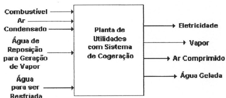
Figura 39. Planta de Utilidades Implementando a Cogeração.
