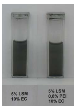
Figura 4.9 - Estabilidade das suspensões sem e com o dispersante PEI observadas pela técnica de decantação.
