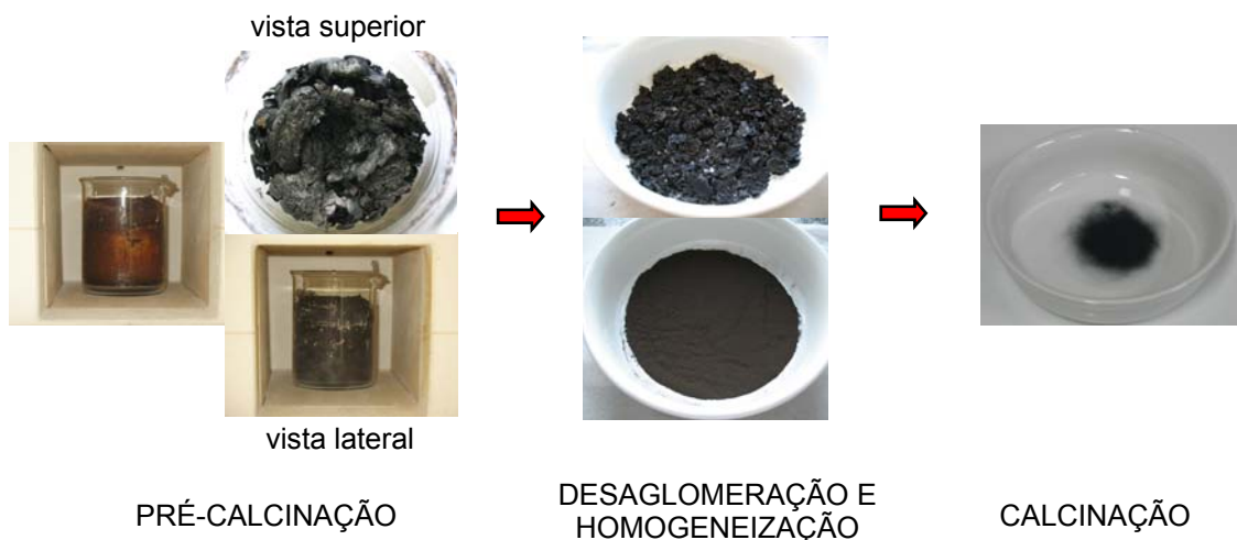
Figura 4.3 - Seqüência ilustrativa das etapas de pré-calцинаção da resina, desaglomeração, homogeneização e calcinação para a formação do material sintetizado de LSM.
