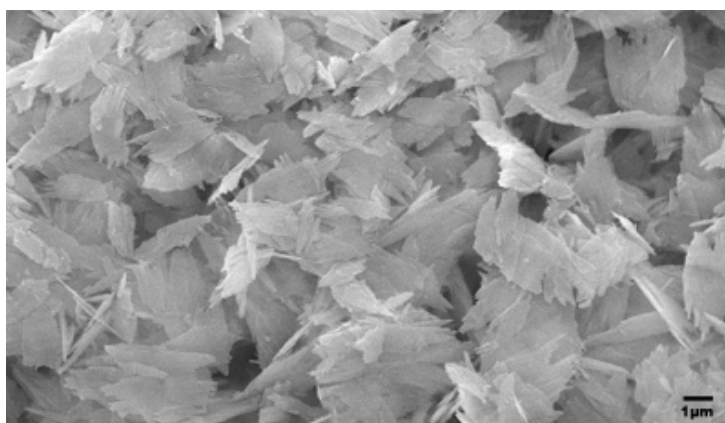
FIGURA 21 - Micrografia dos pós de CtrY como recebido
