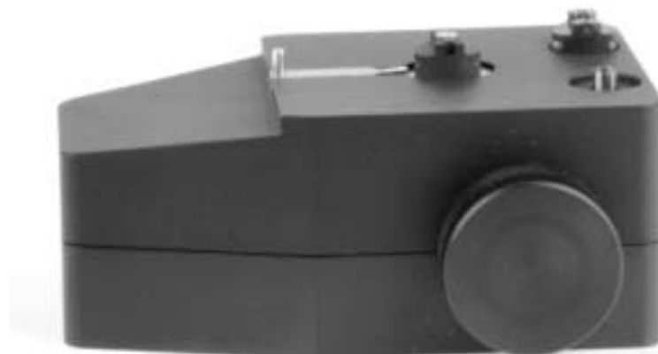
FIGURA 3.4.5.2 – Dispositivo para montagem da amostra no sistema de fixação.
