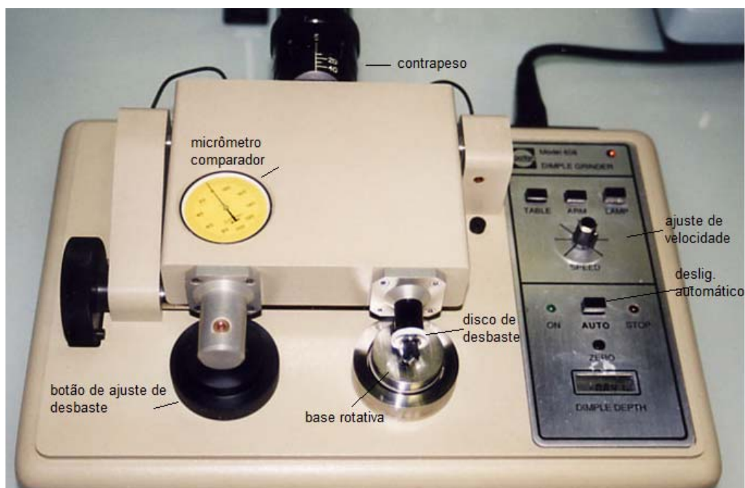
FIGURA 3.4.4.1 “Dimpler” Gattan utilizado na preparação da amostra pré- afinada.
